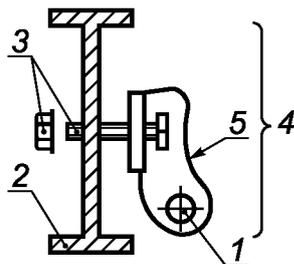
1 — анкерная точка; 2 — структура; 3 — элемент крепления; 4 — анкерное устройство; 5 — элемент
