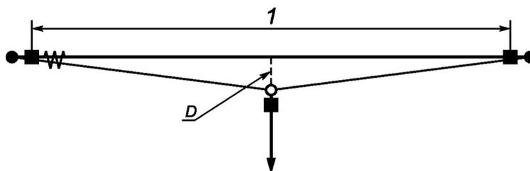
1 — наиболее длинный/короткий пролет;  $D$  — динамический прогиб; ■ — датчик нагрузки; —> — направление приложения нагрузки;  $\text{W}$  — амортизатор энергии (если установлен); ● — концевой анкер; ○ — мобильная анкерная точка
