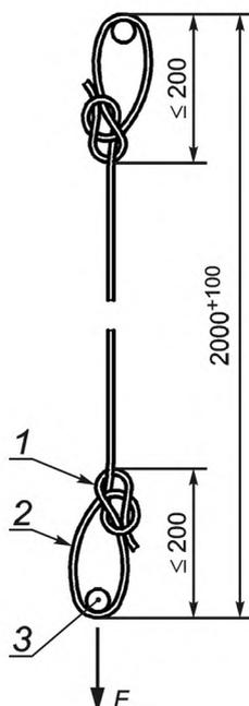
$F$  — усилие эквивалентное  $(100 \pm 1)$  кг; 1 — узел булинь; 2 — окончание стропа в виде петли; 3 — точка закрепления
